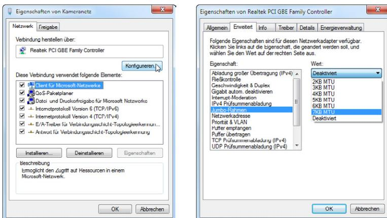
Im Register Erweitert finden Sie die Konfiguration für die Jumbo-Frame-Unterstützung.
