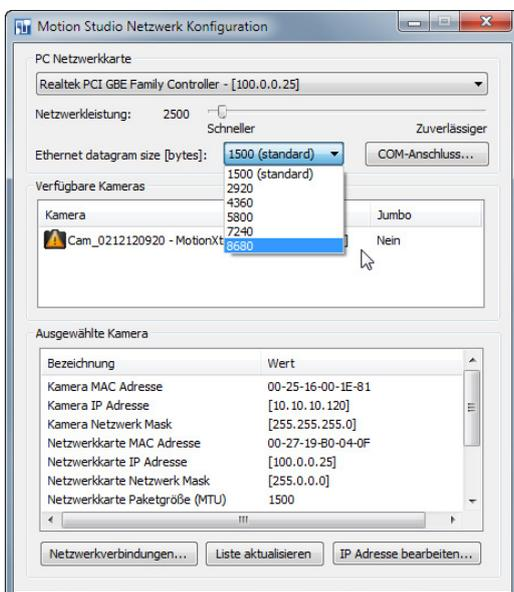
Wählen Sie im Menüpunkt Ethernet Datagram Size einen Wert der geringer ist, als der Maximalwert in der Konfiguration der Netzwerkkarte.
