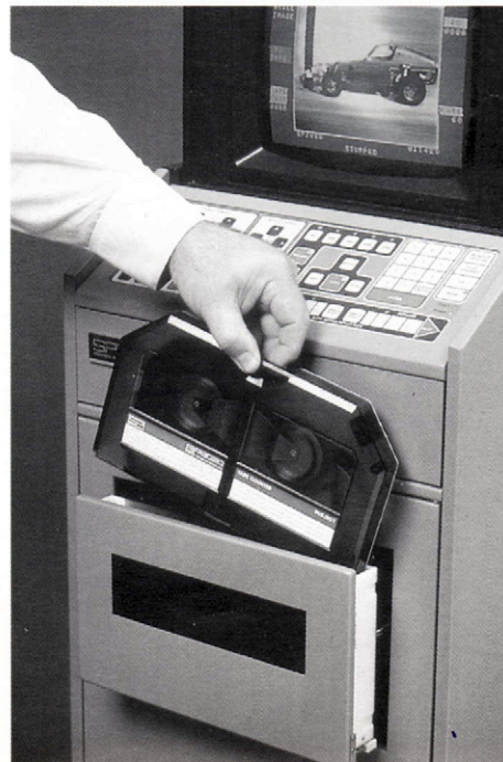
Leichte Handhabung durch kassettenkonfektioniertes Spezialmagnetband
